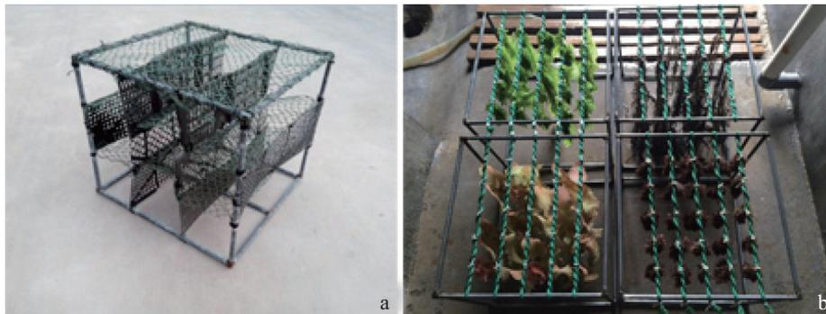
图2 模型礁(a)和海藻丛(b)结构图
